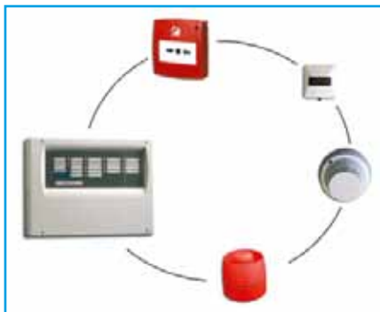
Volledige brandmeldinginstallatie, bestaande uit rookmelders, handmelder, een centrale met doormelding en een ontruimingsinstallatie (geluidsalarm)
